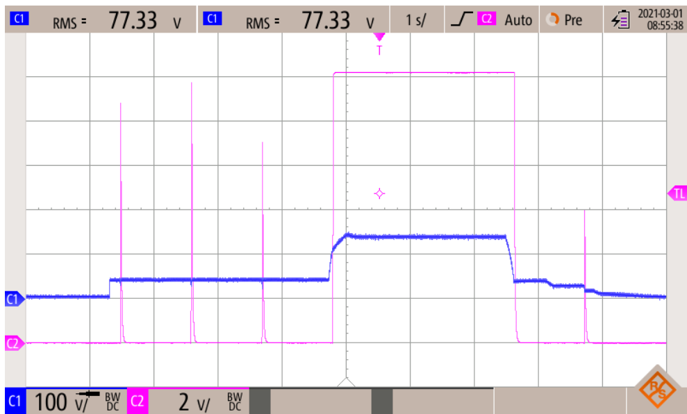
Obr. 69: Odezva na skokovou změnu vstupního napětí, V_{in} = 30 \text{ VAC} , I_{out} = 250 \text{ mA}
