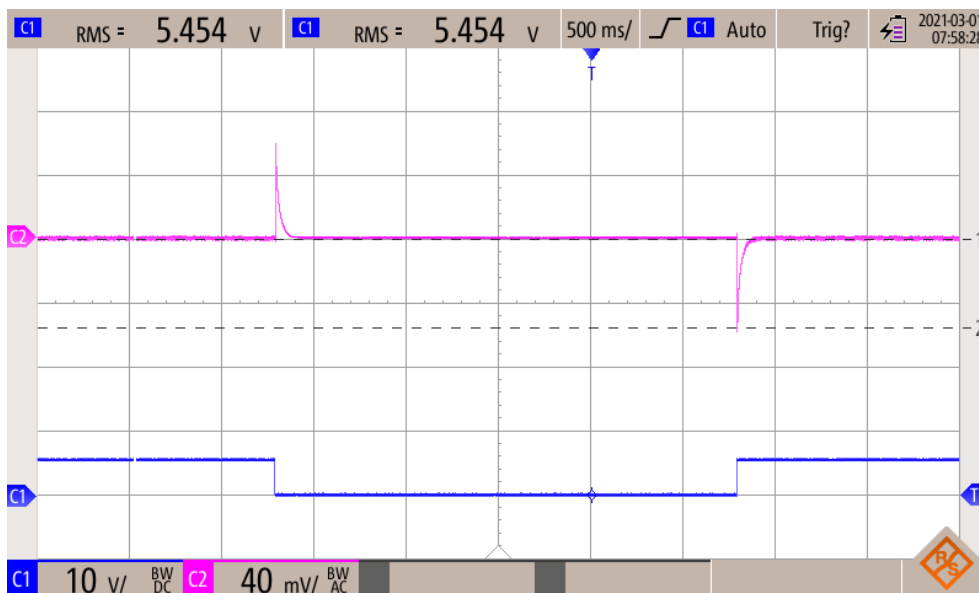
Obr. 72: Odezva na skokovou změnu zátěže, V_{in} = 245 \text{ VAC} , I_{out, \min} = 0 \text{ mA} , I_{out, \max} = 250 \text{ mA}
