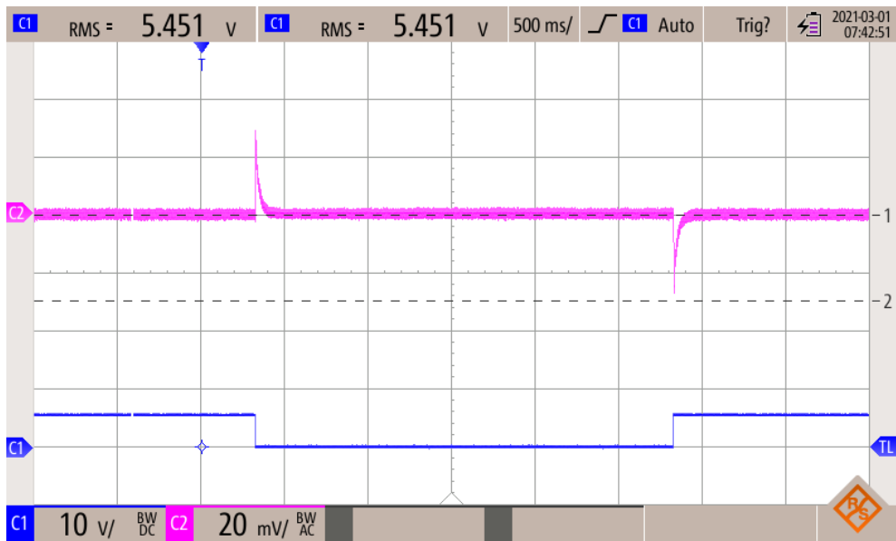
Obr. 75: Odezva na skokovou změnu zátěže, V_{in} = 30 \text{ VAC} , I_{out, \min} = 125 \text{ mA} , I_{out, \max} = 250 \text{ mA}
