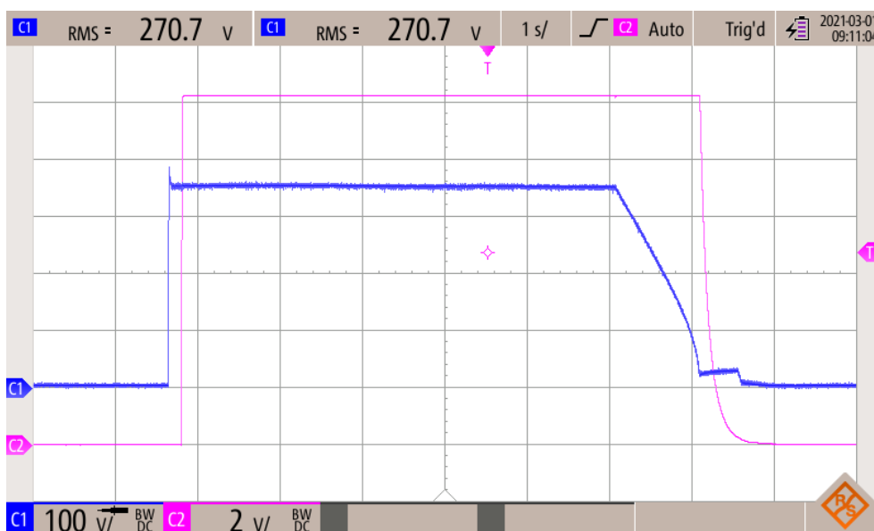
Obr. 68: Odezva na skokovou změnu vstupního napětí, V_{in} = 245 \text{ VAC} , I_{out} = 25 \text{ mA}
