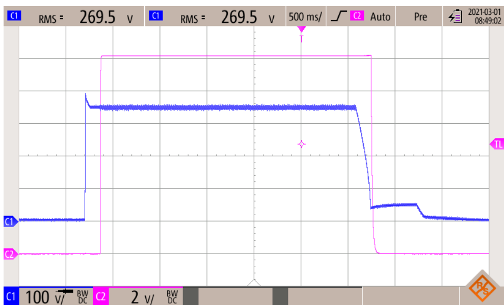
Obr. 70: Odezva na skokovou změnu vstupního napětí, V_{in} = 245 \text{ VAC} , I_{out} = 250 \text{ mA}
